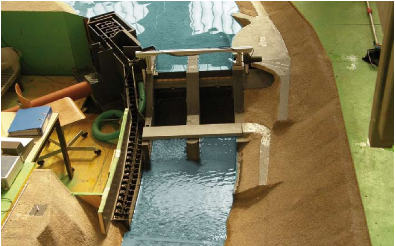
GKI im Kleinformat: Im Wasserbaulabor der Universität Innsbruck werden extreme Abflussereignisse simuliert und umfassend beurteilt.
